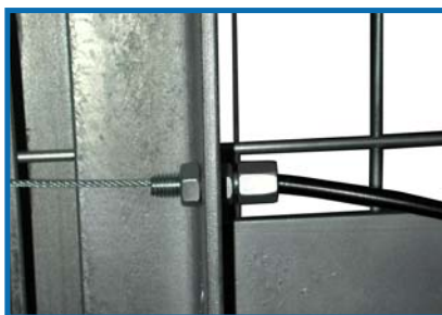
Dettaglio cavo Bowden Ø 2 mm int. - Ø 6 mm est.
