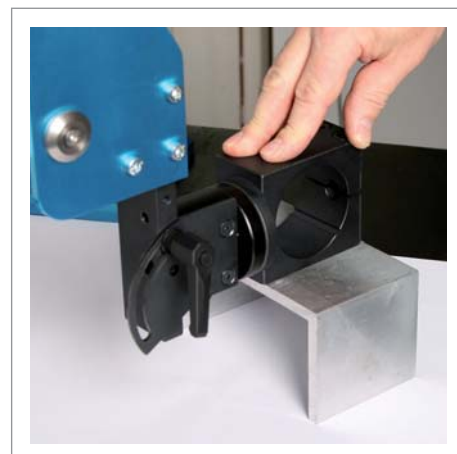
Regolazione rotazione con angolo 90° utilizzando un riferimento.
