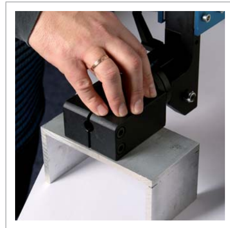
Regolazione angolazione con angolo 90° utilizzando un riferimento.
