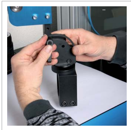
Allentare la manopola per la regolazione dell'angolazione.
